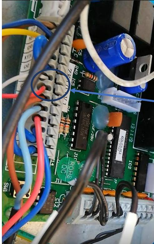
Débrancher les fils du flow switch (généralement rouge et blanc sauf exception et mettre les fils du nouveau détecteur de débit .
