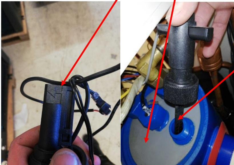
Si jamais après teste le flow switch ne fonctionne pas, il faut débrancher le flow switch de la carte et le remplacer par un nouveau ( faire attention à bien mettre la flèche du flow switch vers les raccord en le revissant).
